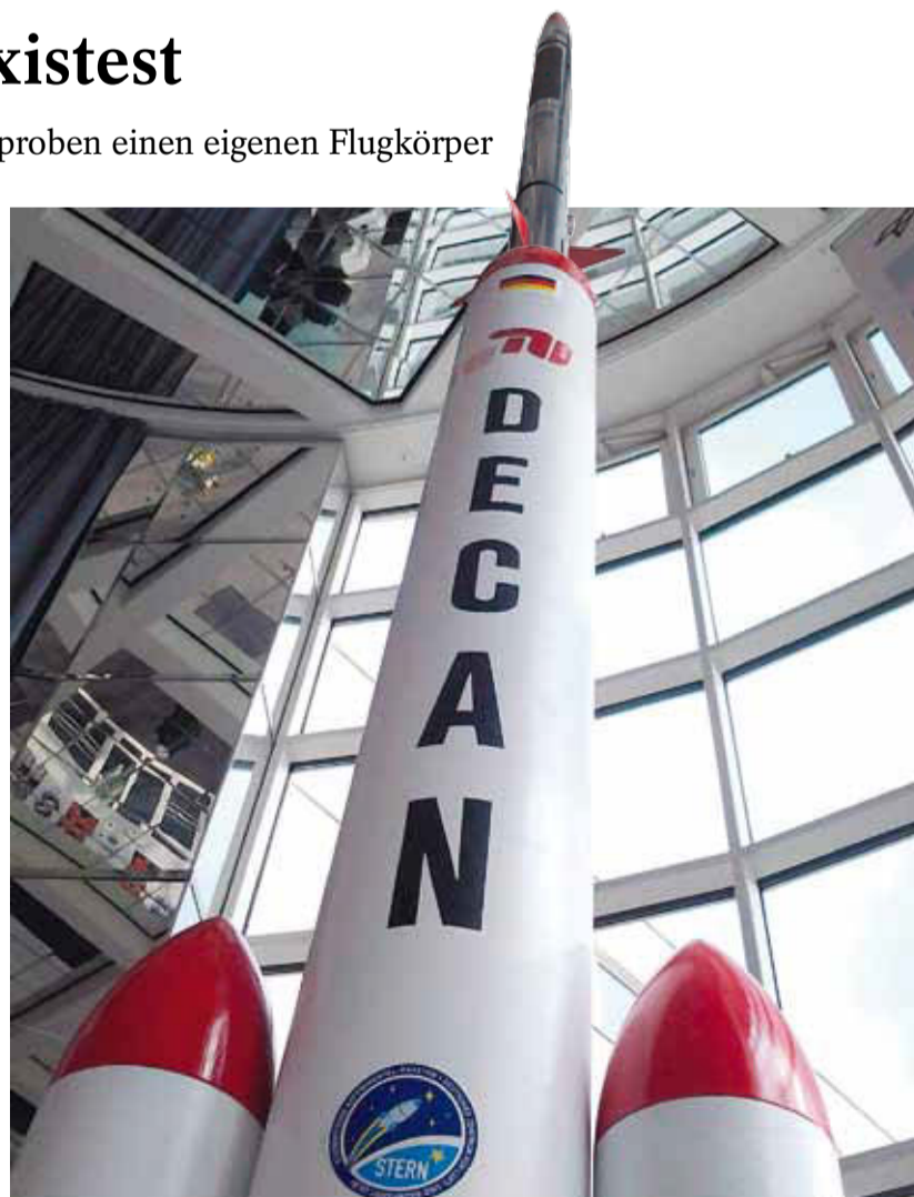
Die TU-Rakete soll später kleine Nutzlasten bis zu sieben Kilometer hoch transportieren
